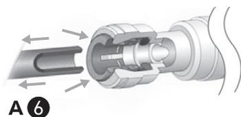
3. Zum Lösen des Schlauches aus dem Schnellverschluss darf der Trinkwasser-Zulaufschlauch (A-6) nicht mehr unter Druck stehen. Entfernen Sie den Sicherheitsstift (A-11), schieben Sie den Sicherungsring ganz nach hinten und ziehen Sie anschließend nur den Trinkwasser-Zulaufschlauch (A-6) aus der Schnellverschluss-Öffnung.
