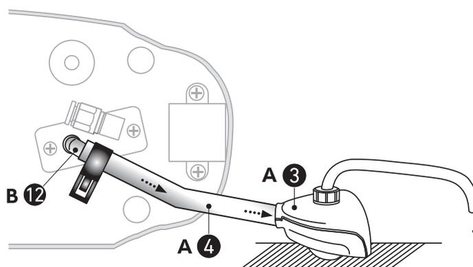
**Hinweis:** Achten Sie darauf, dass der basische Auslaufschlauch (A-2) oder der Edelstahl-Auslauf vom sauren Wasserhahn (A-3) nicht mit verschmutzten Gegenständen in Berührung kommen. Ebenso sollte der Kunststoffschlauch für saures Wasser 7/9mm (A-4) nicht direkt an den Abfluss angeschlossen werden. Dies könnte eine Rückverkeimung des Gerätes verursachen.
