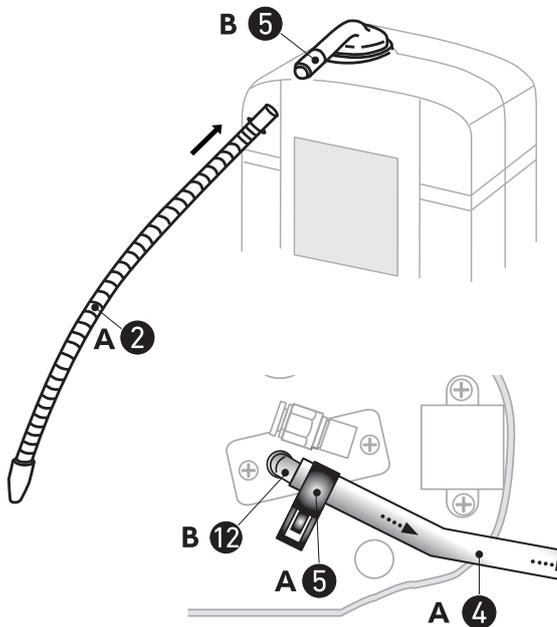
1. Schrauben Sie den basischen Auslaufschlauch (A-2) an den oberen Wasserauslauf (B-5).
