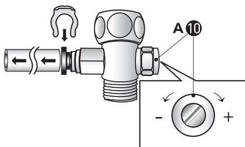
**Hinweis:** Ist der Wasserdruck zu hoch, erscheint im Display (B-22) die Meldung „Error 4“ oder „Error F“. Ist der Wasserdruck zu gering, schaltet sich das Gerät automatisch aus.
