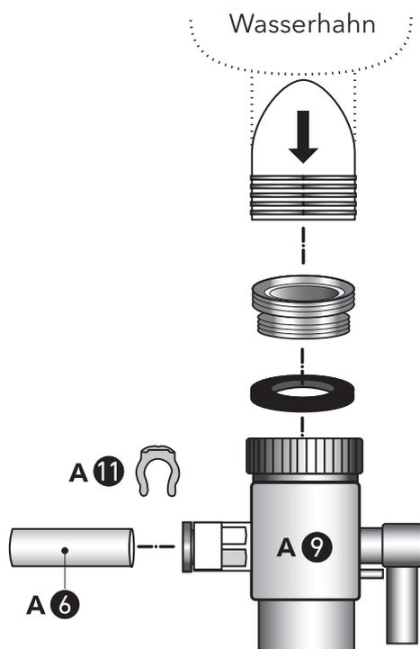
1. Entfernen Sie den Perlator am Wasserhahn und ersetzen Sie diesen mit dem mitgelieferten Umschaltperlator (A-9). Je nach Gewindeart (Innen- oder Außengewinde) kommt das Zwischenstück zum Einsatz.
