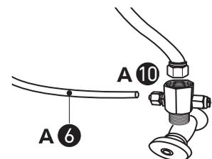
**ACHTUNG:** Achten Sie darauf, dass die Anschlusszapfen am T-Stück bei der Montage nicht seitlich knicken. Dadurch kann ein Haarriss entstehen, der aufgrund des ständigen Wasserdrucks sogar zum Bruch führen kann.
