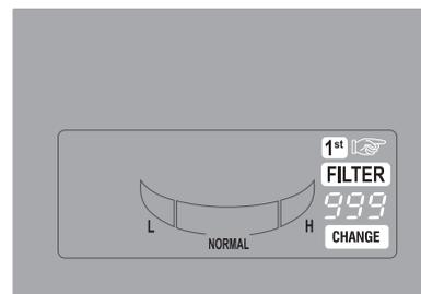
Filter Nr. 2 hat eine maximale Durchflusskapazität von 3.600 Liter Wasser. Diese Durchflussmenge ist erreicht, sobald im Display bei Filter Nr. 2 (B-20) die Zahl 999 aufscheint und auf den Filterwechsel hingewiesen wird.
