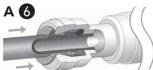
1. Der Trinkwasser-Zulaufschlauch (A-6) muss mindestens 1 cm tief in die Schnellverschluss-Öffnung eingeführt werden.
