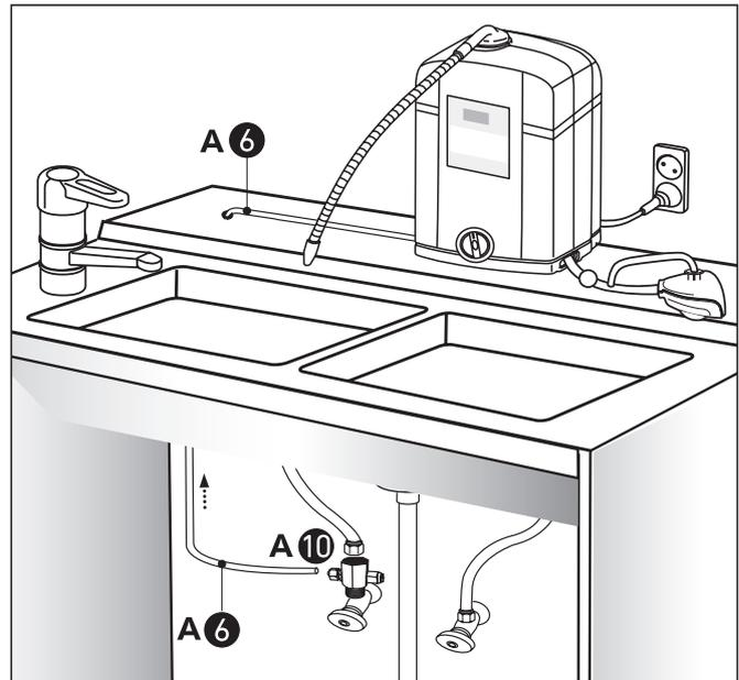
4. Verbinden Sie das andere Ende vom Trinkwasser-Zulaufschlauch (A-6) mit der Schnellverschluss-Öffnung vom Wasserzulauf (B-11) an der Unterseite des ECAIA ionizer S und fixieren Sie den Sicherheitsstift 1/4" (A-11).
