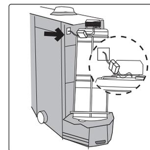
7. Setzen Sie die Filterabdeckung (B-4) in die am Gerät vorgesehene Stelle und schieben Sie diese nach unten, bis sie einrastet. Wenn die Filterabdeckung nicht einrastet, lösen Sie die Fixierung der Filterabdeckungsverriegelungstaste.
